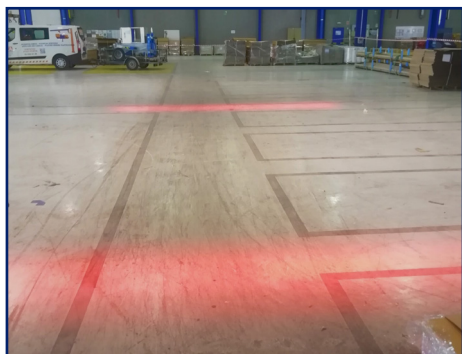
Signe lumineux réel sur la chaussée qui délimite la zone d'action du pont roulant
