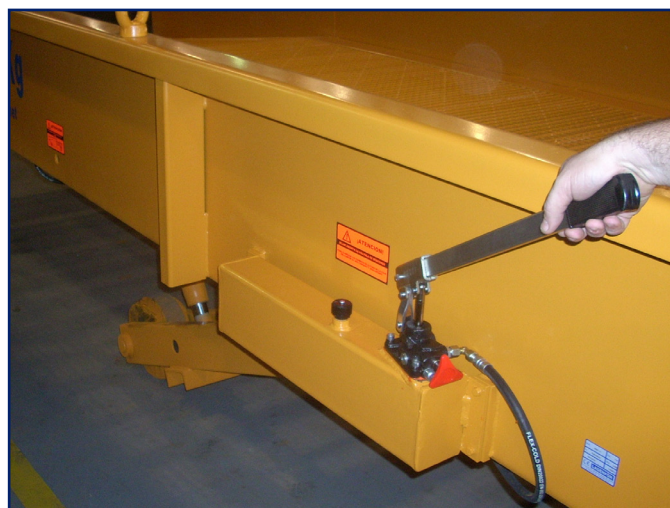
Levage/abaissement avec pompe manuelle.
